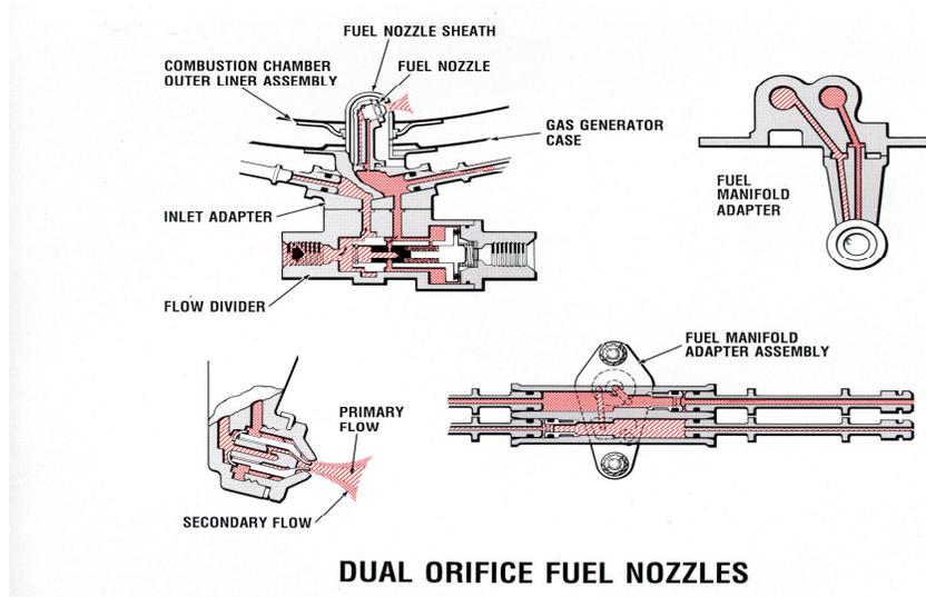
**DUAL ORIFICE FUEL NOZZLES**
