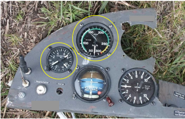
Bild 10 Beschleunigungsmesser und Fahrtmesser (gelbe Kreise O)
