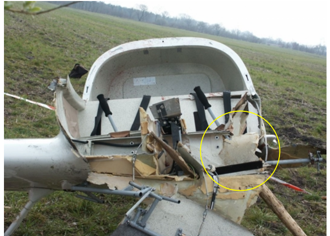
Bild 5 Primärbruchstelle (gelber Kreis O)
